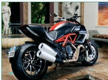
chi da 50 mm con finitura in nero, completamente regolabile nel freno idraulico in compressione ed estensione e nel precarico molla. In entrambe le versioni, la moto è dotata di monoammortizzatore posteriore Sachs in posizione bassa e orizzontale sotto il telaio.
