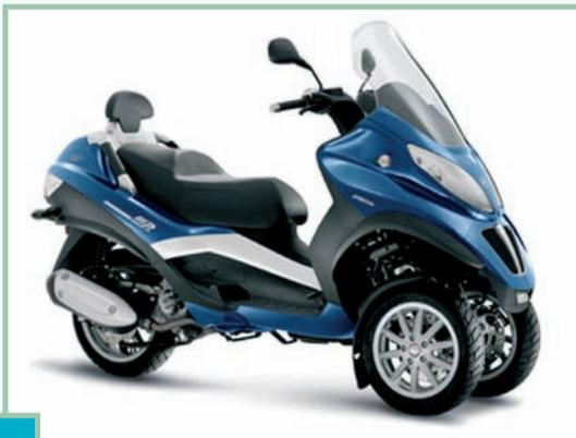
una potenza di 34 Cv a 7.600 giri e una coppia di 37,6 Nm a 5.500 giri. Molto particolare la sospensione anteriore che serve due ruote, a quadrilatero articolato con quattro bracci in alluminio che sostengono due tubi sterzo, cinematisimo della sospensione a bielletta tirata con asse ruota a sbalzo.
