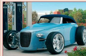
**M**eccanica Volvo per la V8 Speedster realizzata dalla Caresto del designer svedese Leif Tufvesson. È una vettura in alluminio e fibra di carbonio con un propulsore V8 di 4.400 cc. Il motore, ha una potenza di 340 CV ed equipaggia solitamente la Suv Volvo XC90, in questo caso però è stato convertito all'uso di etanolo, carburante ecologico molto utilizzato in Svezia. Il costo di questa particolare auto? Circa 300.000 euro.
